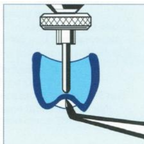
Messen der Wandstärke Measuring of wall thicknesses Mesure de l'épaisseur de paroi Medición del espesor de la pared
